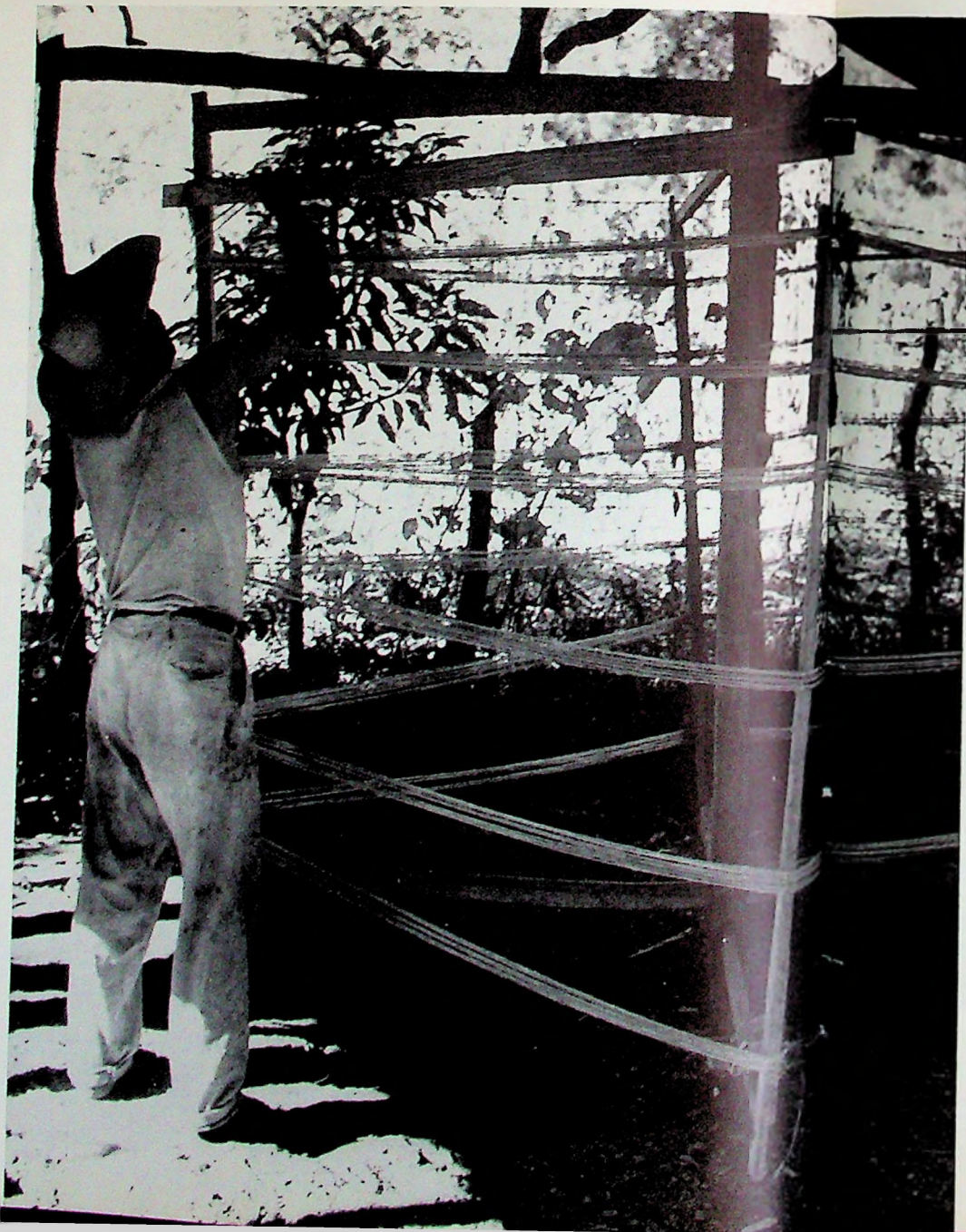
La urdidera o "urdidor", armazón giratoria a la cual traslada el artesano los seis hilos que vienen del pelotero, manteniéndolos unidos y bien tensos, va disponiéndolos, arrollados en forma helicoidal.
