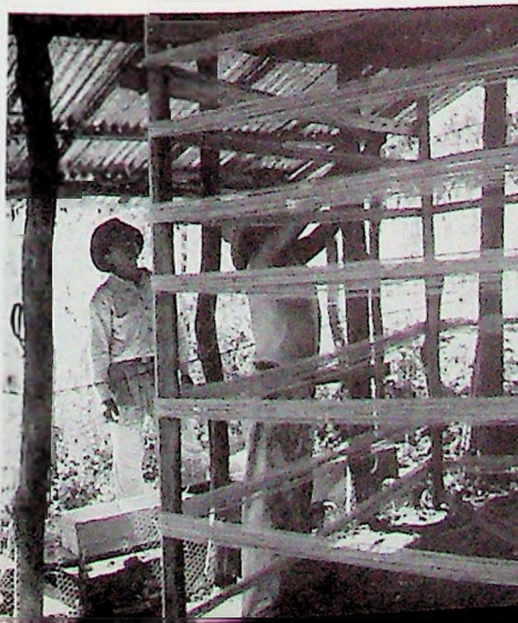
La labor en la urdidera ha sido concluida, y el operario se dispone a retirar del aparato, la madeja de cordales de tique que ha formado. El indio cordillerano que le acompaña, y el cual desempeñará el oficio de tejedor, observa, atento, la operación.
