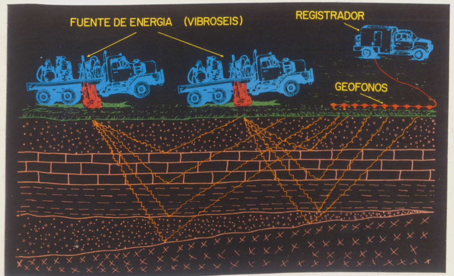
Gráfico demostrativo del sistema de reflexión vibroseis con sus tres elementos principales.
