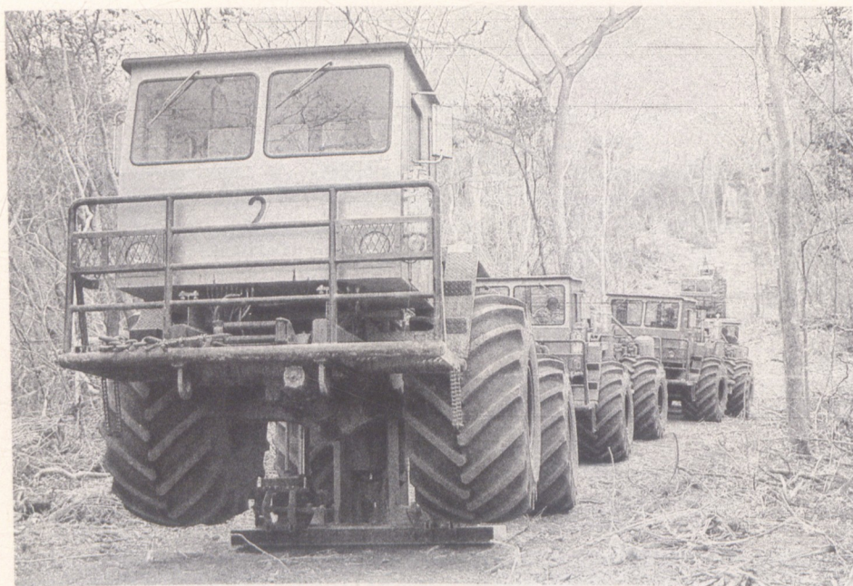
Todo un espectáculo ofrecen estos camiones de articulación hidráulica en el momento de suministrar la energía necesaria que será detectada por los geófonos.
