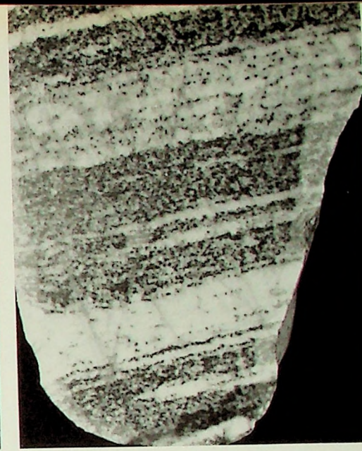
Arriba Izq.: Fragmento de diorita cuarcífera, roca ígnea granuda, común en la mayor parte de la Cordillera Andina. Arriba Der.: Roca metamórfica (gneis) con la misma composición mineralógica que los granitos, que con frecuencia se la encuentra en las Guayanas y en algunas zonas de los Andes. Izquierda: Muestra de obsidiana, vidrio natural, que forma parte de las lavas de los volcanes de los Andes. Esta roca fue utilizada por los Incas para confeccionar espejos. Abajo Izq.: Microfotografía de una andesita que integra buen número de lavas de los volcanes andinos. Abajo Der.: Porfírita cuarcífera, en un fragmento pulimentado, que suele formar diques en los Andes colombianos.
