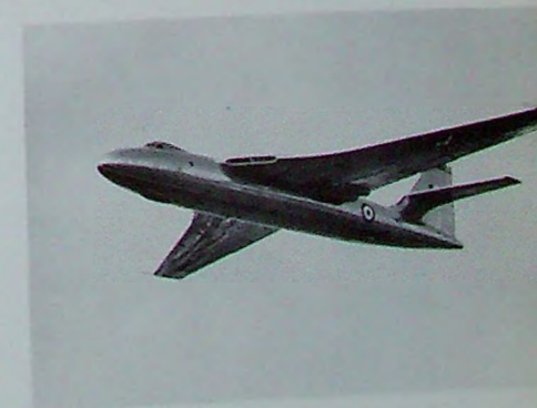
El nuevo bombardero Vickers "Valiant" en vuelo. Es movido por cuatro turbinas de propulsión a chorro marca Rolls Royce "Avon". Se cree que éste es el bombardero que puede funcionar mejor en el mundo, entre los de su clase.
