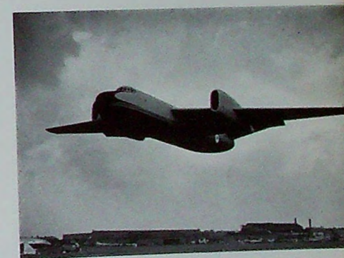
El Short S.A.4 — un nuevo bombardero británico de reacción a chorro, movido por cuatro turbinas Rolls Royce "Avon". Se cree que éste sea, tal vez, el bombardero más rápido que existe, aunque los detalles de sus posibilidades se mantienen todavía secretos.
